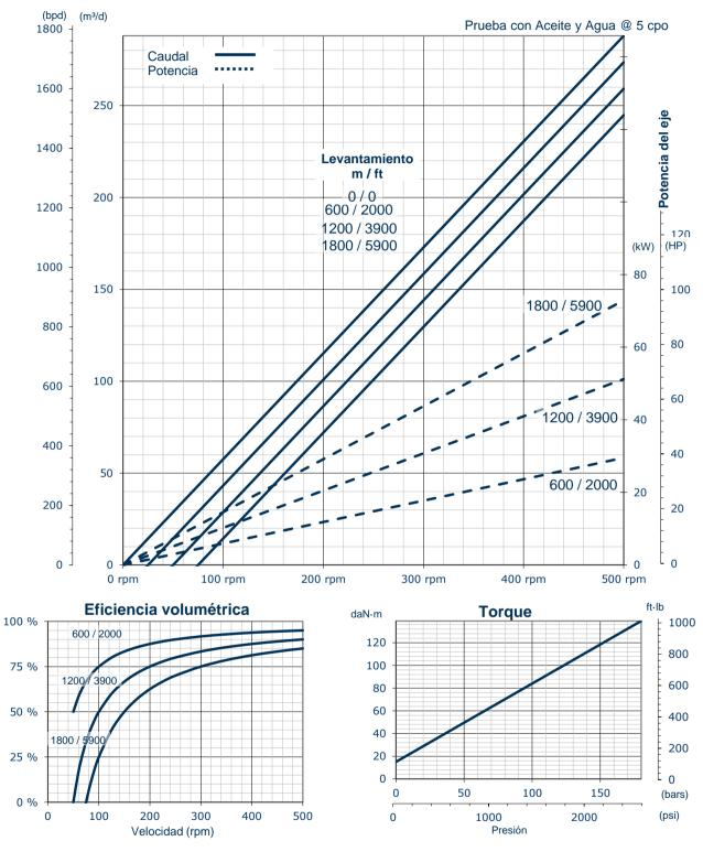
El gráfico del caudal se calcula utilizando el valor del desplazamiento validado de esta bomba.
